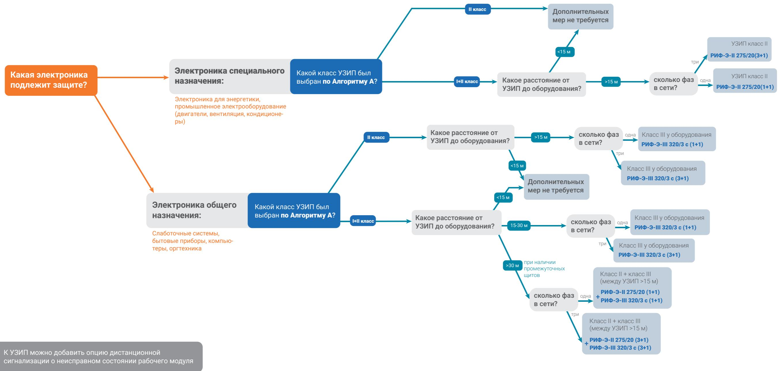
Защитив сеть, т.е. установив «грубую» защиту в виде УЗИП I, I+II или II класса в ГРЩ/ВРУ, следует ответить на вопрос, есть ли внутри объекта дорогостоящее электронное оборудование, уязвимое для помех, или оборудование, помехостойкость которого неизвестна (рисунок 8).
