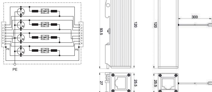
Принципиальная схема РИФ-И 48/0,5/10 (8)-кат6 (А) РИФ-И 48/0,5/10 (8)-кат6 (Б)
