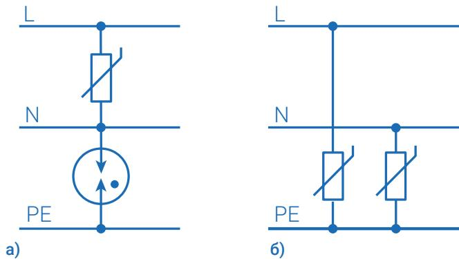
**Рис. 15**– Схемы включения УЗИП для защиты:
