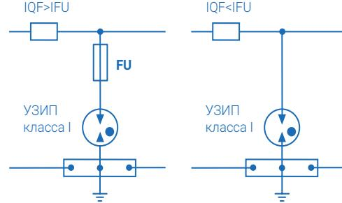
**Рис. 12.** – Подключение УЗИП класса I
