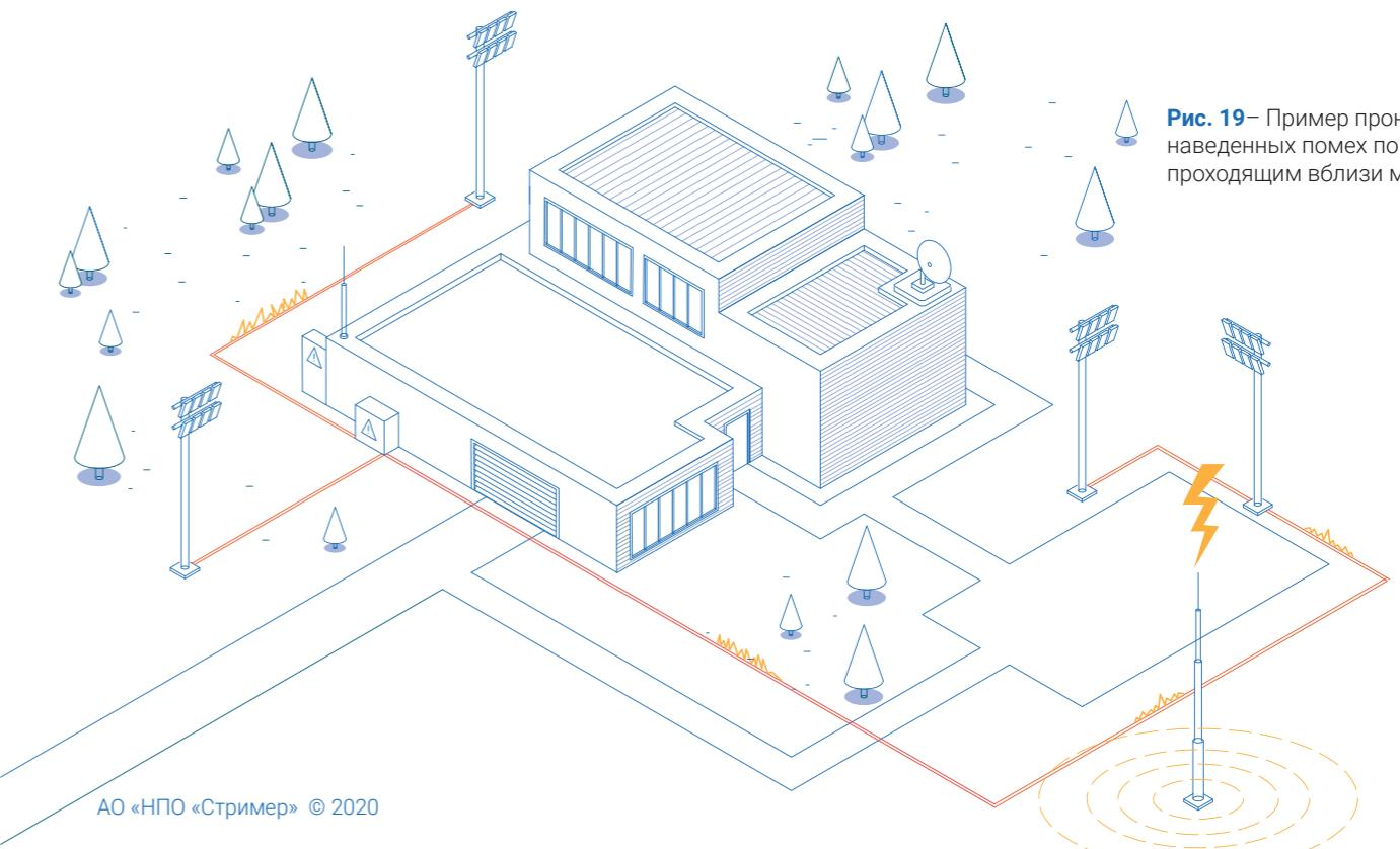
**Рис. 19** – Пример проникновения наведенных помех по КЛ, проходящим вблизи молниевводов
