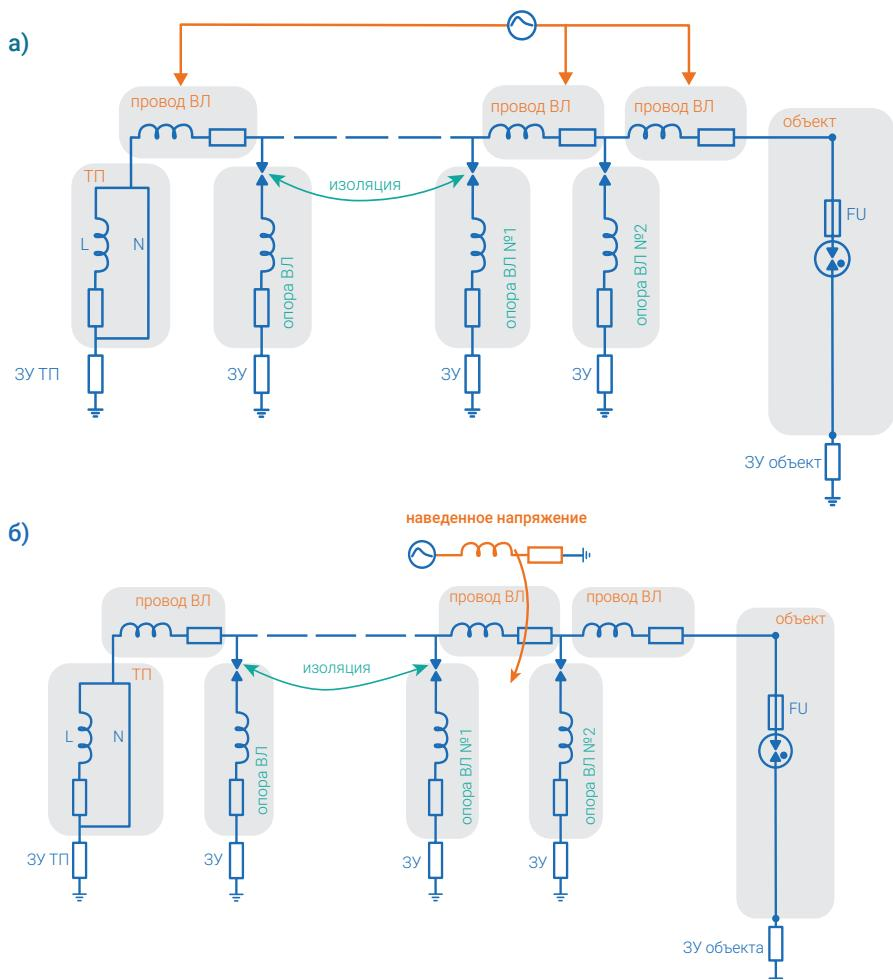
**Рис. 14** – Схемы замещения для оценки токов через УЗИП при отсутствии у объекта системы молниезащиты и наличии отходящей ВЛ 0,4 кВ: а) отходящая ВЛ проходит по открытой местности; б) отходящая ВЛ экранирована соседними объектами
