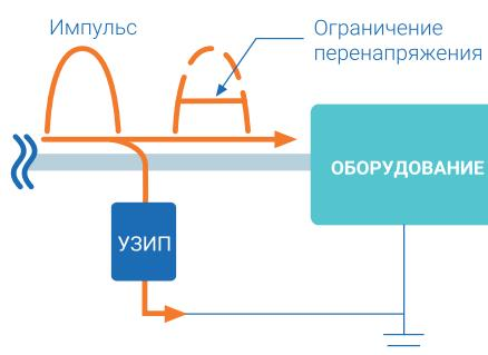
управления, видеонаблюдения и т.п.). Обязательно необходимо применять УЗИП для защиты размещенного на конструкциях с молниеотводами прожекторного оборудования, систем вентиляции и видеонаблюдения на кровлях зданий.
