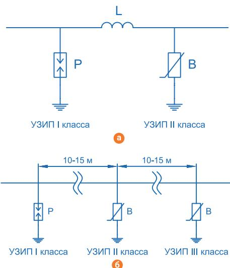
**Рис. 10.** Обеспечение селективной работы УЗИП:
