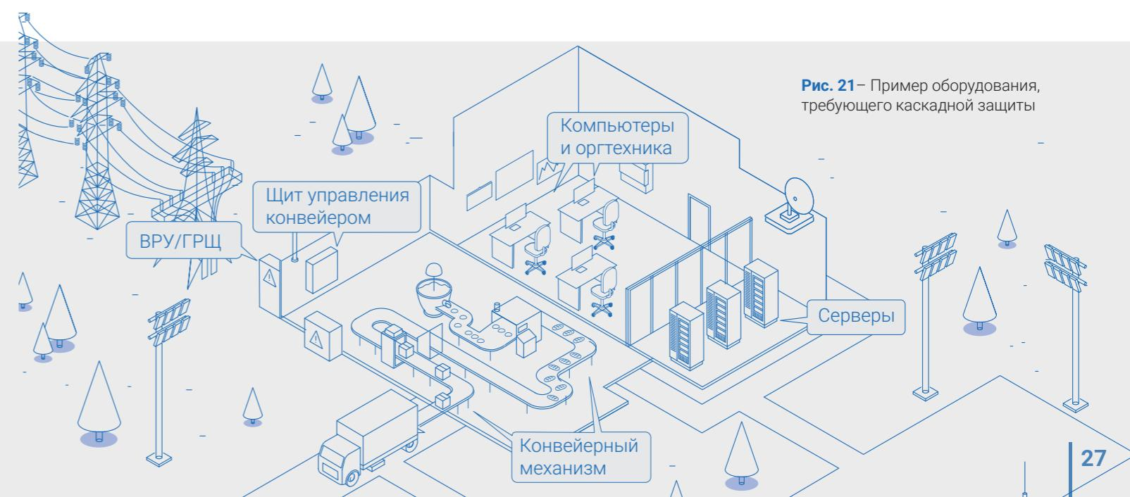
Рис. 21 – Пример оборудования, требующего каскадной защиты
