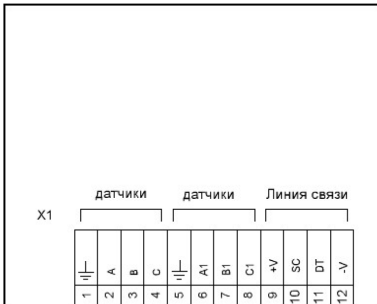
Схема подключения коммутатора СКВН
