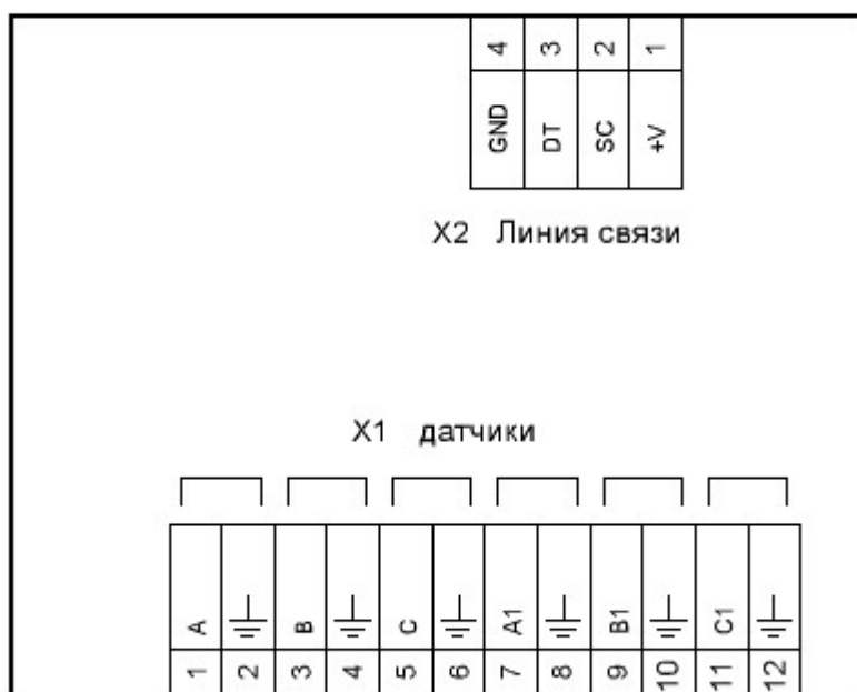
Схема подключения коммутатора СКВН2
