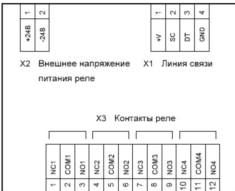
Схема подключения модуля дискретных выходов
