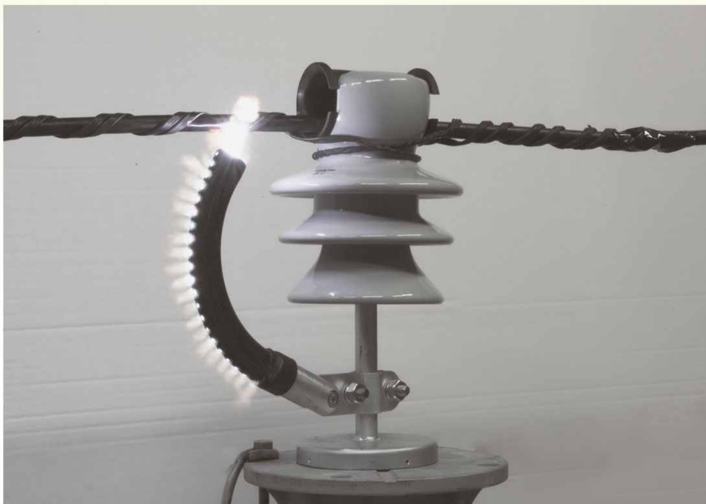
Рис. 12. Разрядник мульти-камерный на 10 кВ, для защиты от индуктированных перенапряжений (PMK-10-И);
